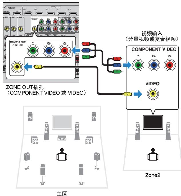
若要将 MONITOR OUT/ZONE OUT 插孔分配到 Zone2 视频监视器，请将“设定”菜单中的“显示器输出分配”（第 125 页）设置为“Zone2”。
