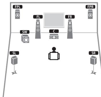
该音箱系统使用前置现场感音箱生成自然的 3 维声场，也会使用环绕声音箱向真实声场中添加深远的感觉，创建 Virtual Surround Back Speaker (VSBS)。该系统不仅仅适合享受 5.1 声道，而且也适合享受 7.1 声道的内容。
