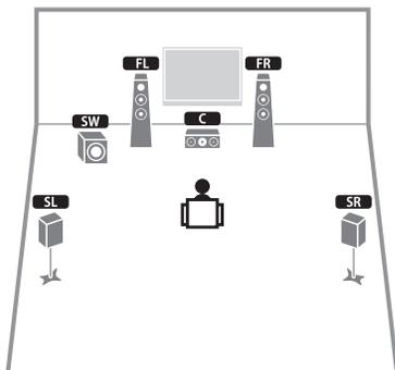
该音箱系统使用前置、中置和现场感音箱生成自然的三维声场，创建 Virtual Presence Speaker (VPS)，也会使用环绕声音箱向真实声场中添加深远的感觉，创建 Virtual Surround Back Speaker (VSBS)。该系统不仅适合享受 5.1 声道，而且也适合享受 7.1 声道的内容。
