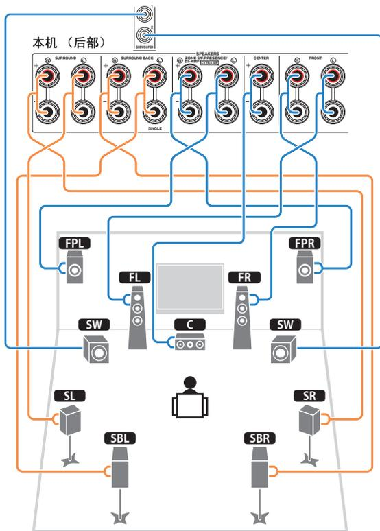
**!** 只使用一个后环绕声音箱时，将其连接至 SINGLE 插孔（左侧）。
