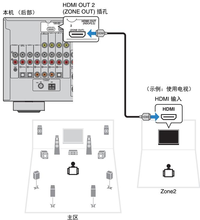
若要将 HDMI OUT 2 (ZONE OUT) 插孔分配到 Zone2，请将“设定”菜单中的“HDMI OUT2 分配”（第 125 页）设置为“Zone2”。
