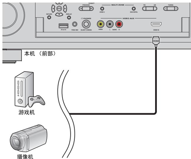
如果通过按遥控器上的 V-AUX 选择“V-AUX”作为输入源，则将从本机输出在装置上播放的视频/音频。
