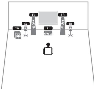
即使将环绕声音箱放置在前侧，将“设定”菜单中的“扬声器配置（环绕声）”（第 115 页）设置为“前”时，本机创建的虚拟后置环绕音响能够让您体验多通道环绕声（Virtual CINEMA FRONT）。
