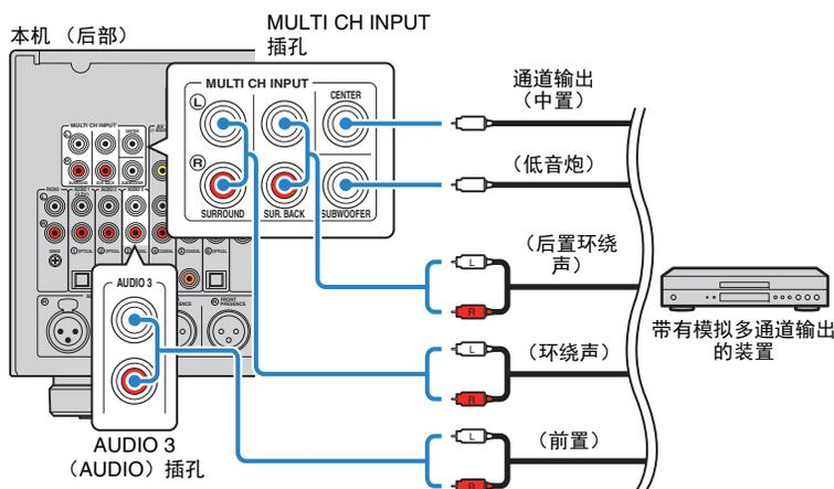
如果通过按遥控器上的 MULTI 选择“MULTI CH”作为输入源，则将从本机输出在装置上播放的音频。
