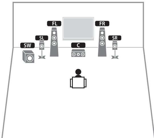
即使将环绕声音箱放置在前侧，将“设定”菜单中的“扬声器配置（环绕声）”（第 126 页）设置为“前”时，本机创建的虚拟后置环绕音响能够让您体验多通道环绕声（Virtual CINEMA FRONT）。
