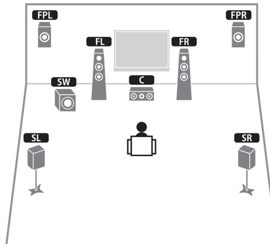
该音箱系统使用前置现场感音箱生成自然的 3 维声场，也会使用环绕声音箱向真实声场中添加深远的感觉，创建 Virtual Surround Back Speaker（VSBS）。该系统不仅仅适合享受 5.1 声道，而且也适合享受 7.1 声道的内容。
