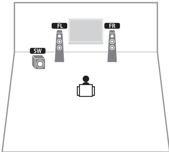
即使在未连接环绕声音箱的情况下，本机也可使用前置音箱创建虚拟环绕声音箱来让您欣赏多声道环绕声（Virtual CINEMA DSP）。
