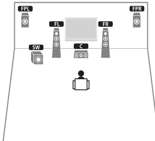
本音箱系统使用前现场感音箱建立自然的三维声场，并使用前置音箱创建虚拟环绕声音箱来让您欣赏多声道环绕声（Virtual CINEMA DSP）。
