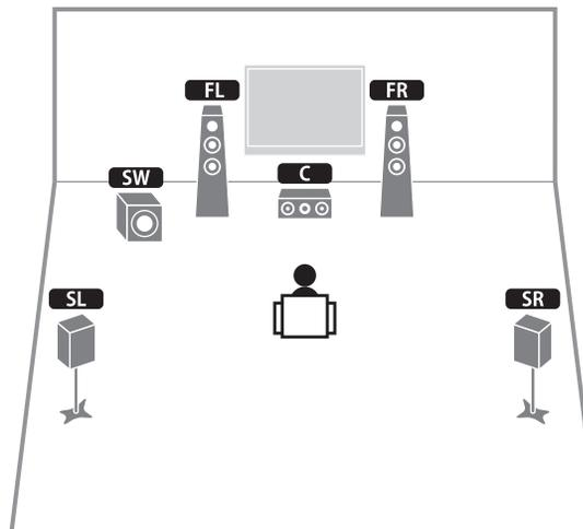
该音箱系统使用前置、中置和现场感音箱生成自然的三维声场，创建 Virtual Presence Speaker（VPS），也会使用环绕声音箱向真实声场中添加深远的感觉，创建 Virtual Surround Back Speaker（VSBS）。该系统不仅仅适合享受 5.1 声道，而且也适合享受 7.1 声道的内容。
