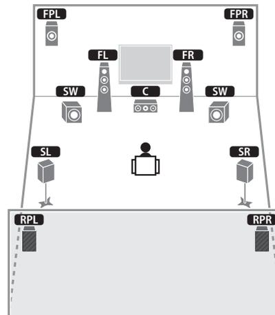
该音箱系统使用前置和后置现场感音箱生成高度自然的 3 维声场，也会使用环绕声音箱向真实声场中添加深远的感觉，创建 Virtual Surround Back Speaker (VSBS)。该系统不仅仅适合享受 5.1 声道，而且也适合享受 7.1 声道的内容。
