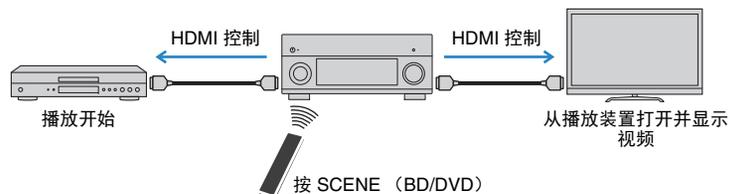
若要使用 HDMI 控制，您需要在连接电视和播放装置后执行以下 HDMI 控制链接设置。有关电视的设置和操作的详情，请参见电视使用说明书。
