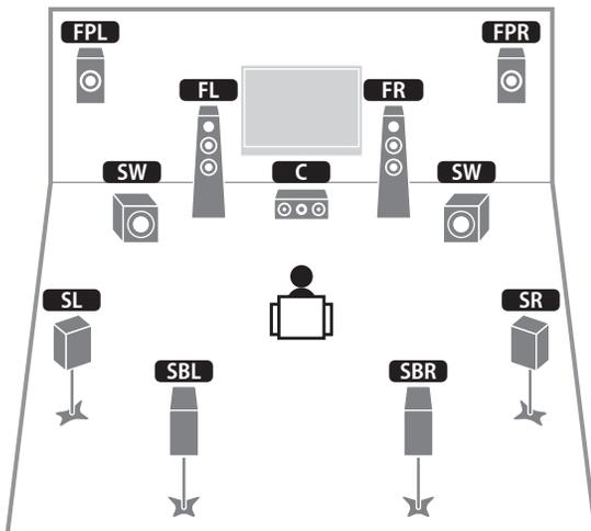
本音箱系统使用前现场感音箱来创建自然的三维声场，您还可以使用后环绕声音箱欣赏增强的环绕声音。
