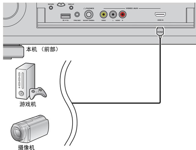
如果通过按遥控器上的 V-AUX 选择“V-AUX”作为输入源，则将从本机输出在装置上播放的视频/音频。
