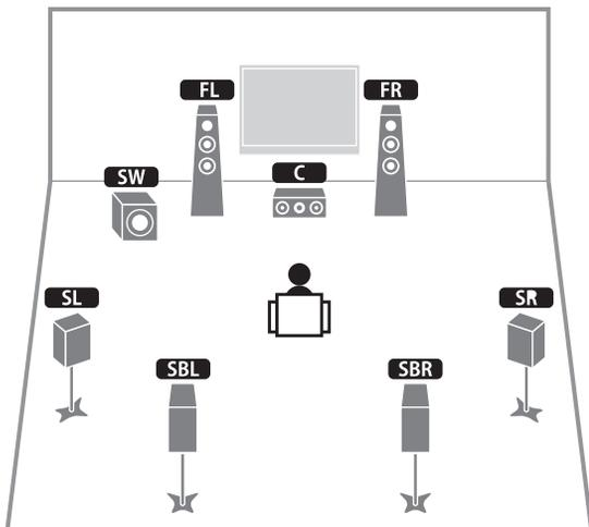
本音箱系统使用前置音箱、中置音箱和环绕声音箱来创建前置 Virtual Presence Speaker（VPS），从而建立三维声场，通过该系统，您还可以使用后置环绕声音箱欣赏增强的环绕声音。
