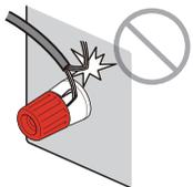
如果打开本机时前显示屏上显示了“Check SP Wires”，则关闭本机然后检查音箱线缆是否短路。
