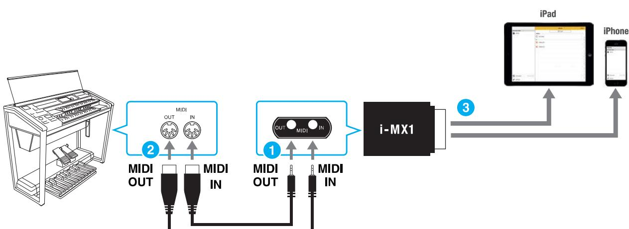
确保i-MX1的MIDI OUT端口与双排键电子琴的MIDI IN端口相连, i-MX1的MIDI IN端口与MIDI OUT端口相连。
